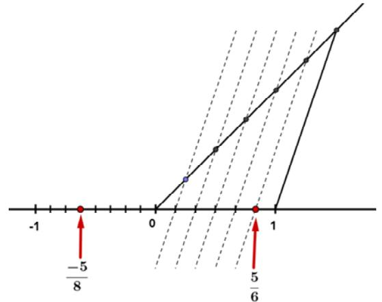
Fíjate que para dividir en 6 partes iguales sólo hay que marcar 5 puntos intermedios a igual distancia, siempre uno menos. Para dividir en 8 partes iguales marcamos 7 puntos intermedios.
